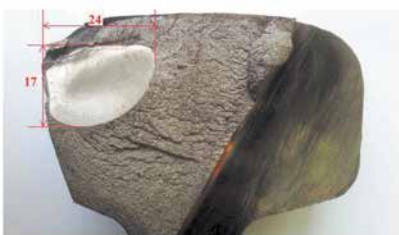
Поперечная трещина по коду 21.2 вскрытая в результате излома дефектного рамного рельса.
