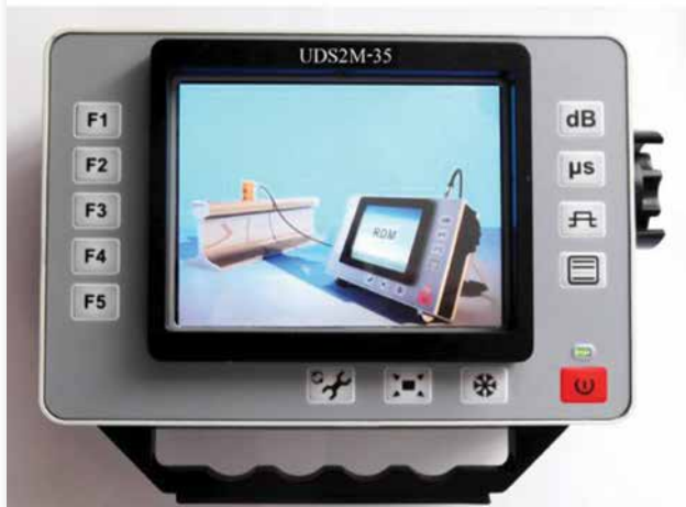
Дефектоскопы РДМ-23 и УДС2М-35 реализуют представление зарегистрированных сигналов в виде 3D дефектограмм
