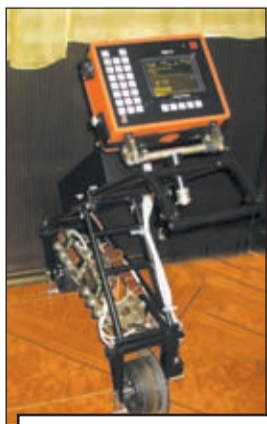
Нам все-таки удалось удивить искушенное сообщество дефектоскопистов своим односторонним дефектоскопом для контроля рельсов - РДМ-12
