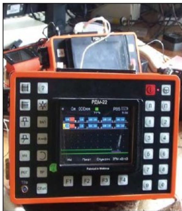
Память РДМ-22 — компьютеризированного дефектоскопа сплошного контроля — способна хранить информацию о состоянии примерно 10 км рельсового пути
